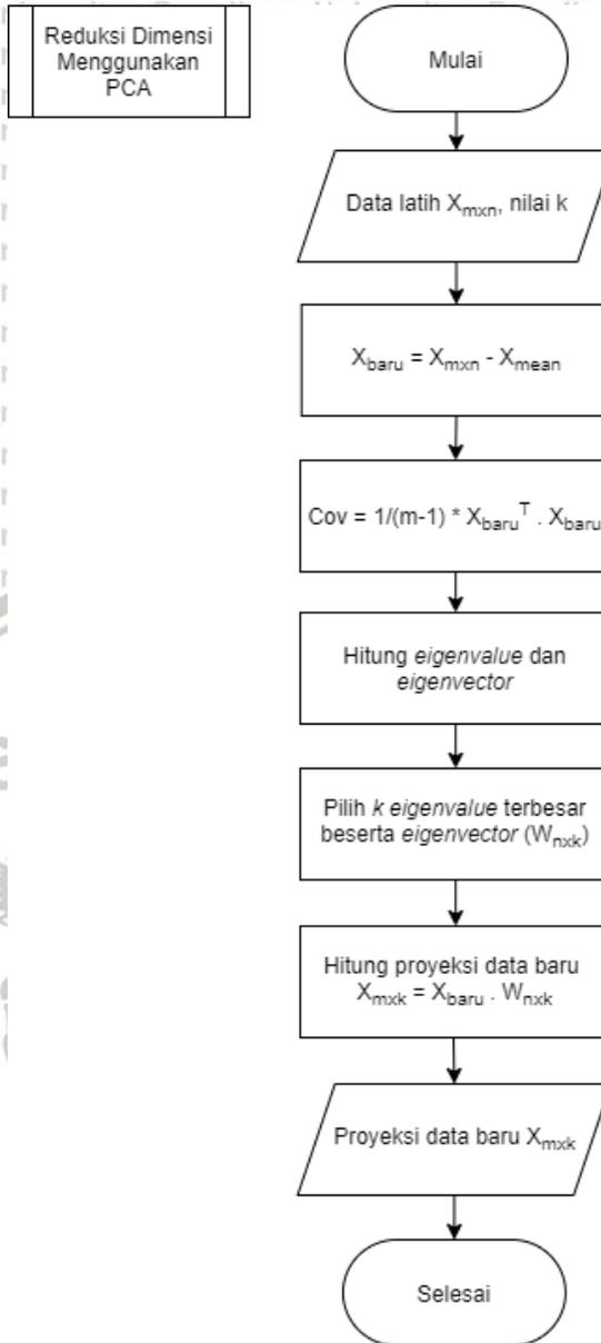
Gambar 4.3 Diagram alir algoritme PCA
