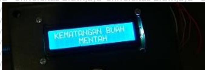
Gambar 6.4 Hasil Pengujian Tampilan LCD 16X2
