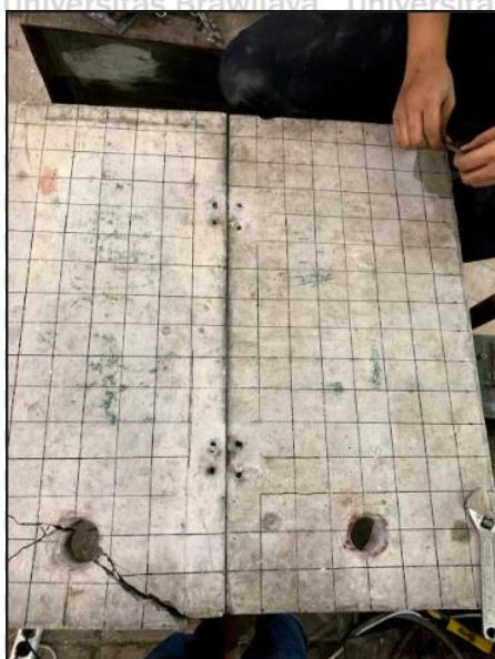
Lampiran L 6. 4 Susunan panel beton onyx setelah dilakukan pengujian
