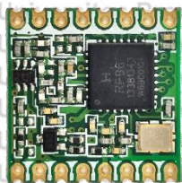
Gambar. 2. 10 RFM95W LoRa Module
