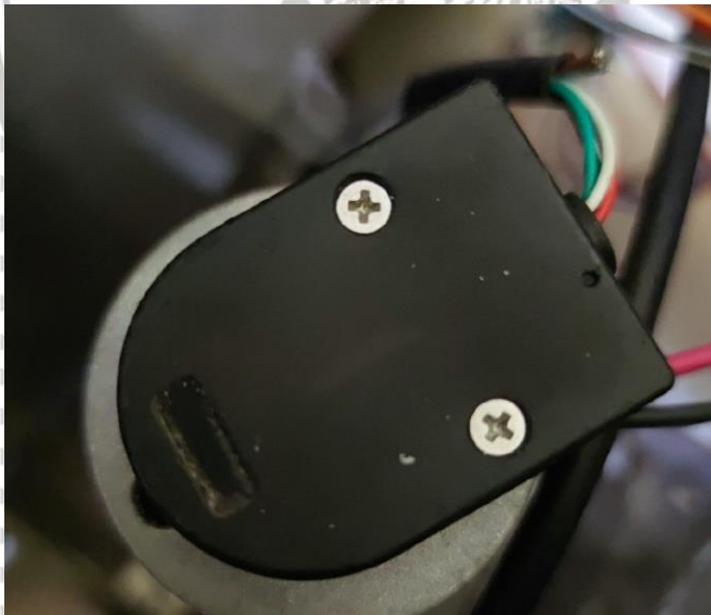
Gambar 3.13 Motor DC yang terhubung dengan rotary encoder
