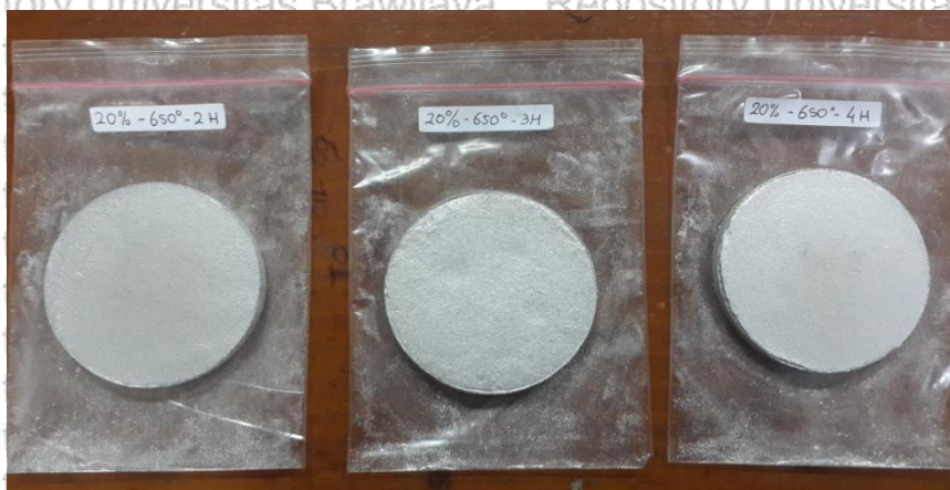
Gambar 7. Spesimen komposit dengan berbagai waktu penahanan pada temperatur sinter 650°C.
