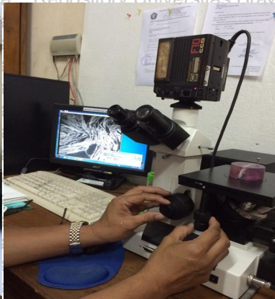
Gambar 6. Pengambilan gambar untuk foto mikro penampang
