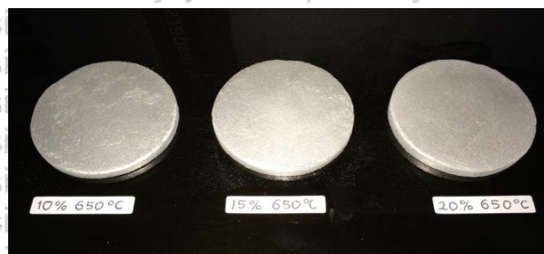
Gambar 4. 5. Spesimen Komposit dalam Berbagai Fraksi Berat
