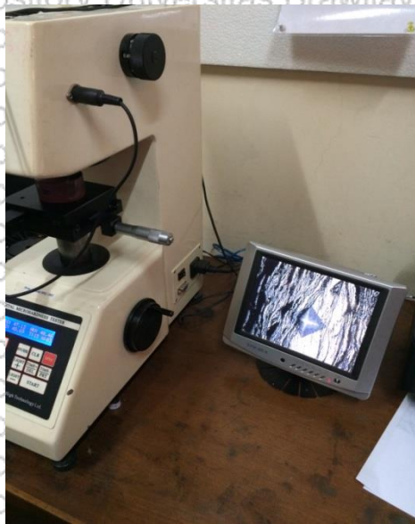
Gambar 6. Pengambilan gambar untuk foto mikro penampang
