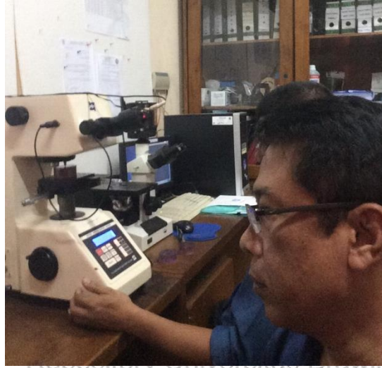
Gambar 5. Pengujian kekerasan penampang
