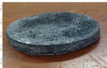
Gambar 5. 7. Spesimen Komposit yang Telah Disinter pada Temperatur 700^{\circ}\text{C}
