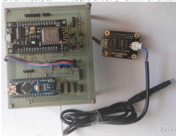
Gambar 5.28 Implementasi Skema Sensor TDS
