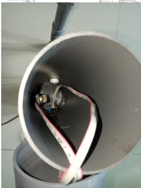
Gambar 6. Foto Sensor dalam Tabung Penampung
