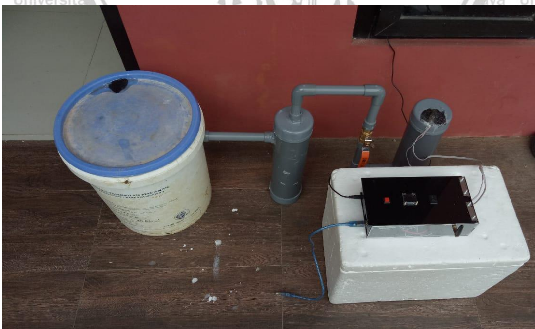
Gambar 2. Foto Rancangan Mekanik Reaktor Biogas Keseluruhan
