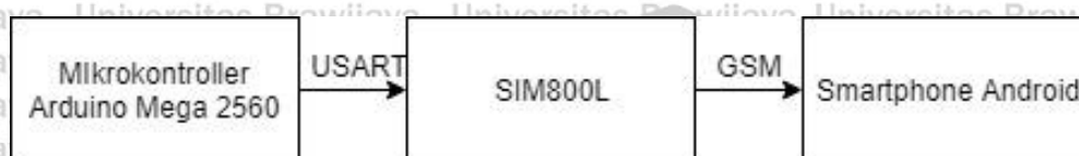
Gambar 4.11. Diagram Blok Rangkaian Pengujian Pengiriman Notifikasi SMS
