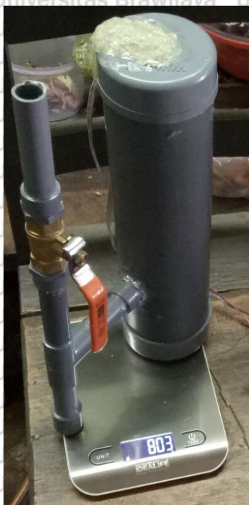
Gambar 4.2. Tabung Penampung Gas Metana
