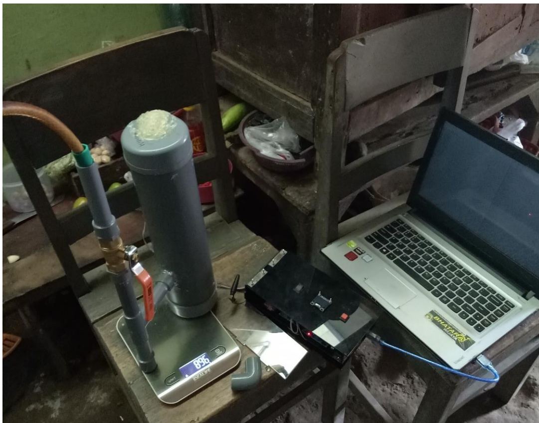
Gambar 1. Pengujian Sensor Gas Metana
