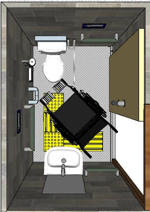
Gambar 4.22 ilustrasi *space aisle* kursi roda (besar) pada area dalam toilet
