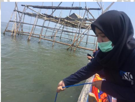
Mengukur kecerahan menggunakan Secchi disk
