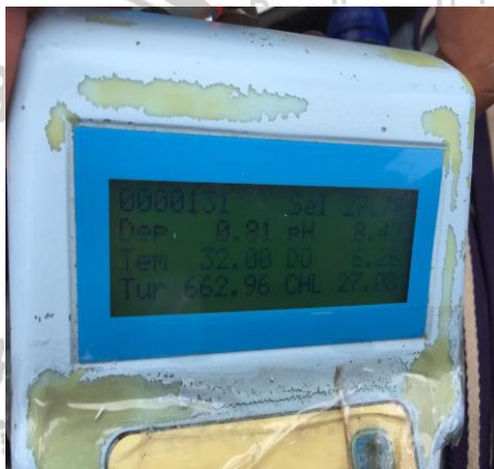
AAQ 1183s untuk mengukur suhu, pH, klorofil, DO, salinitas
