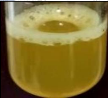
Uji saponin pada campuran
