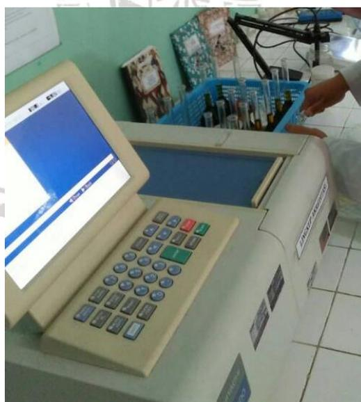
**Gambar 19.** Pengujian Kadar Timbal dengan Spektrofotometer
