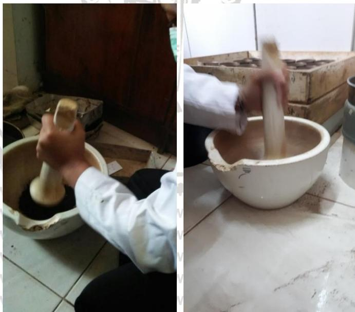
**Gambar 16.** Menghaluskan Sampel Tanah dengan Mortar dan Pistil
