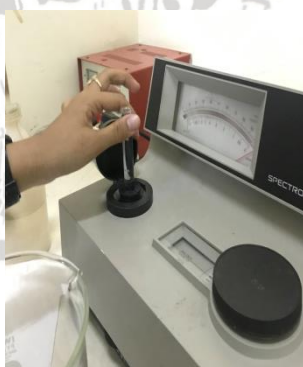
Analisa P-total dengan Spectronic 21
