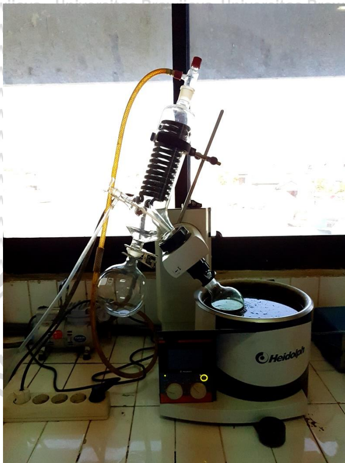
Gambar lampiran 3. Proses Ekstraksi Dengan Rotary Vacuum Evaporator
