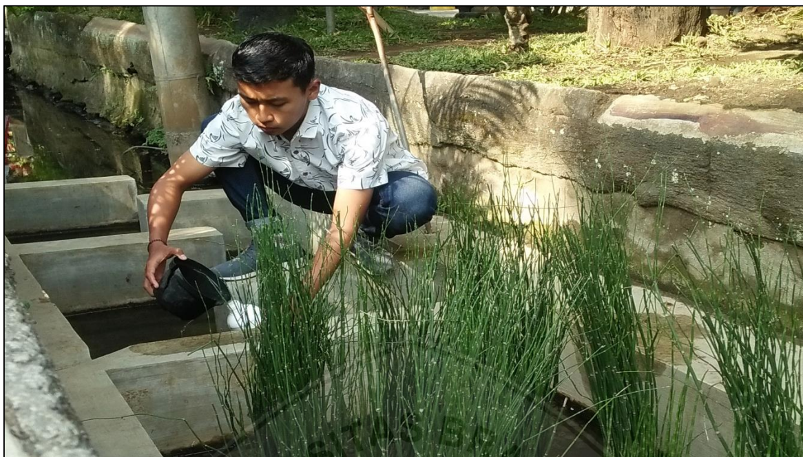
Gambar 4.3 Pengambilan Sampel Air Limbah pada Outlet Bangunan Wetland
