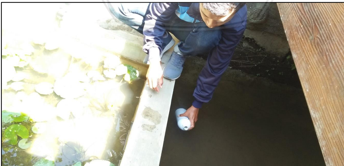
Gambar 4.2 Pengambilan Sampel Air Limbah Pada Inlet Bangunan Wetland
