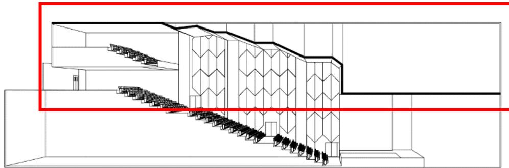
Gambar 4.11 gambar potongan kondisi plafon
