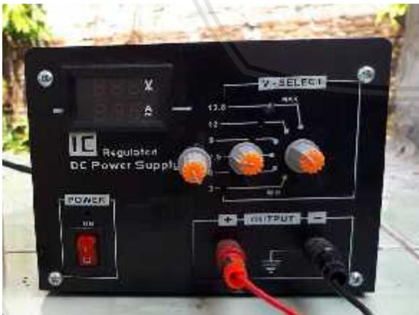
Gambar 3.1 Alat elektrodeposisi
