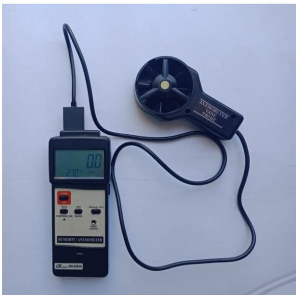
Gambar 3. 4 Anemometer eksterior
