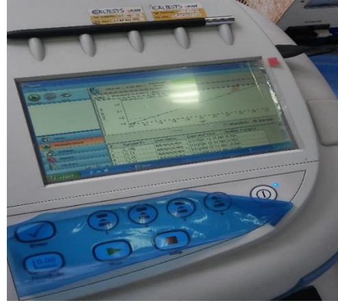
Pengukuran Amonia menggunakan spektrofotometer dengan panjang gelombang 425 nm
