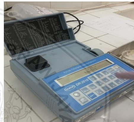
Pengukuran TSS menggunakan spektrofotometer dengan panjang gelombang 810 nm
