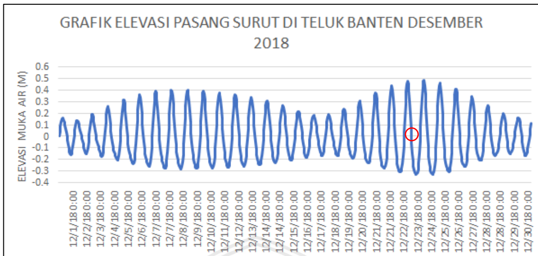
Gambar 22. Grafik Elevasi Pasang Surut Di Teluk Banten Desember 2018 Kondisi Menuju Surut saat Spring Tide
