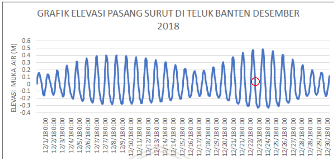
Gambar 20 Grafik Elevasi Pasang Surut Di Teluk Banten Desember 2018 Kondisi Menjelang Pasang saat Spring Tide
