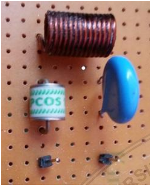
Arester kaskade dengan dekopling 1.1 \mu\text{H}
