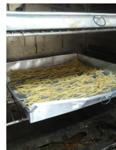
Pengeringan mie menggunakan oven suhu 100°C selama 1 jam
