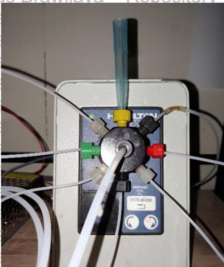
**Gambar L.J.3** *Syringe Valve SIA*
