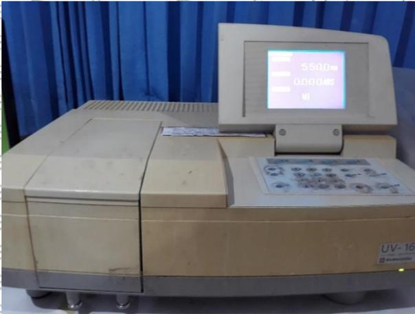
**Gambar L.J.5** Detektor spektrofotometer UV-Vis
