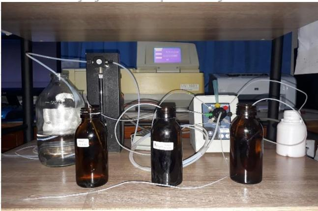
Gambar L.J.1 Rangkaian alat SIA
