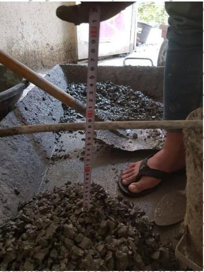
**Gambar 4.3 Pengukuran slump beton segar**
