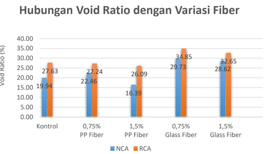
**Gambar 4.5 Grafik hubungan antara void ratio dengan variasi fiber**
