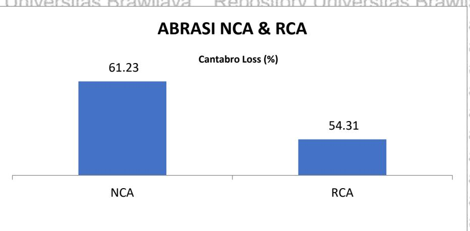
Gambar 4.6.hasil pengujian daya tahan aus pada RCA+NCA
