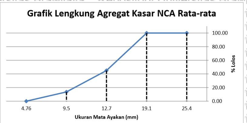
Gambar 4.1 Gradasi Agregat Kasar Alami (NCA)
