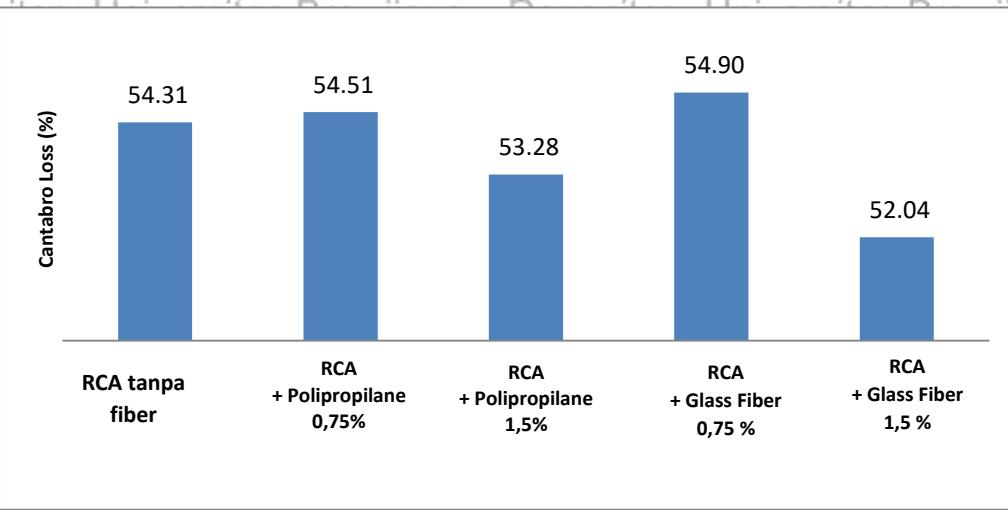
Gambar 4.8. hasil Pengujian Daya Tahan Aus pada RCA+Fiber
