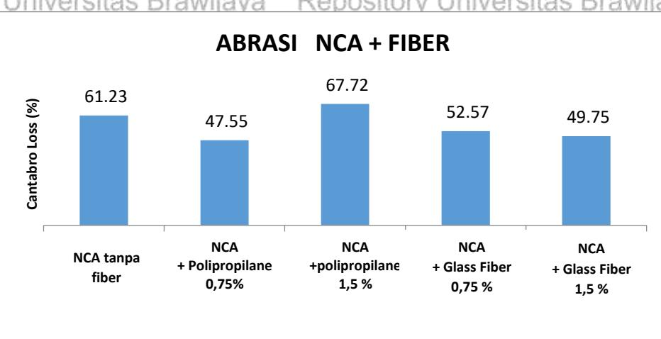
Gambar 4.7. Diagram hasil Pengujian Daya Tahan Aus pada NCA+Fiber
