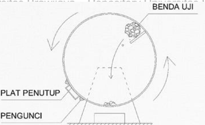
Gambar 3.3 Potongan Melintang Alat Uji Abrasi *Los Angeles*
