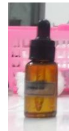
Imersi Oil berfungsi untuk memperjelas objek saat dilihat dibawah mikroskop.
