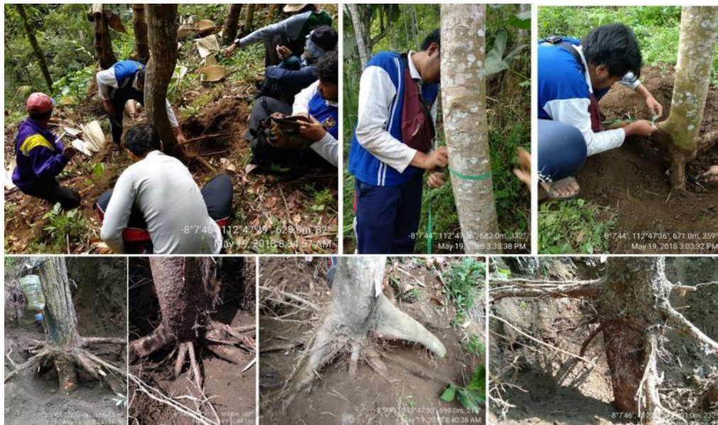
Gambar 3. Pengukuran Diameter Akar Horizontal dan Vertikal untuk Perhitungan IJA dan ICA yang Dibutuhkan dalam Evaluasi Potensi Akar Pohon Sebagai Penguat Tebing
