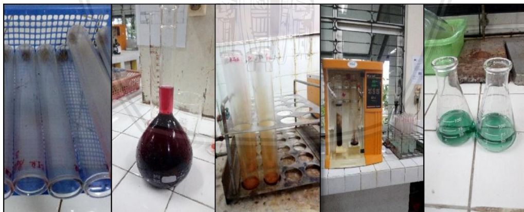
Gambar 9. Proses Analisis N-Total dengan Metode Kjeldhal
