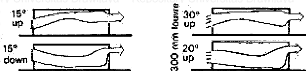
Gambar 2.19 Pengaruh sudut jendela jalousie terhadap pembelokan angin Sumber: Koenigsberger et al. (2013)
