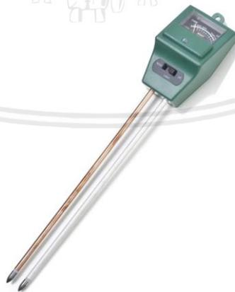
**Gambar 2. 13 Hygrometer Tanah**
