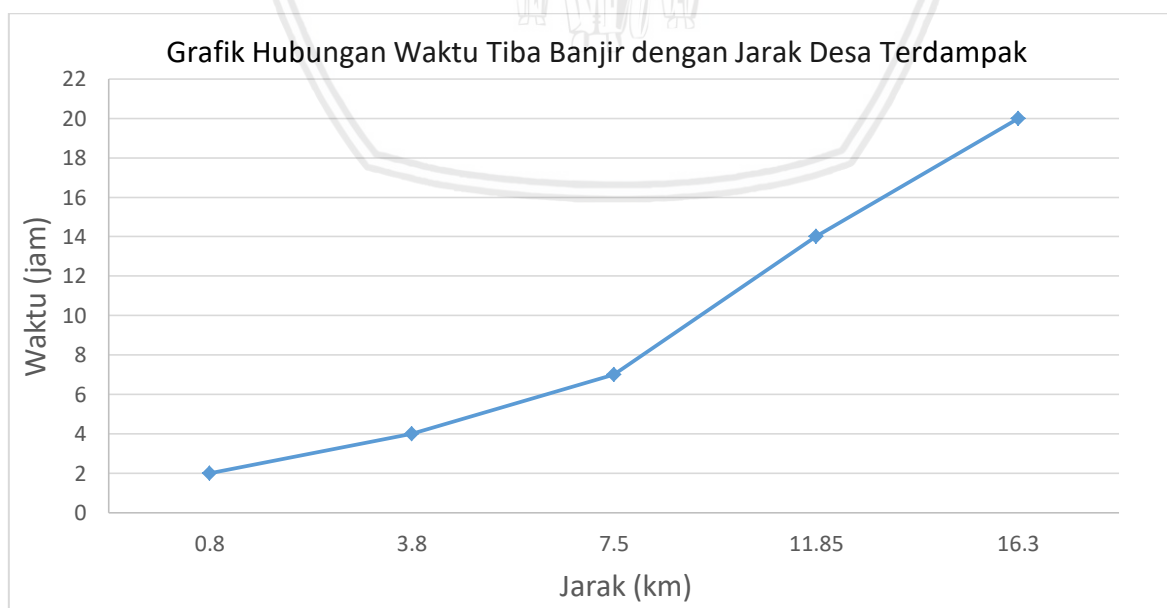
Gambar 4.75 Grafik Hubungan Waktu Tiba Banjir dengan Jarak Desa Terdampak untuk Skenario Keruntuhan Saddle Dam karena Piping Bawah Kondisi Muka Air Banjir
