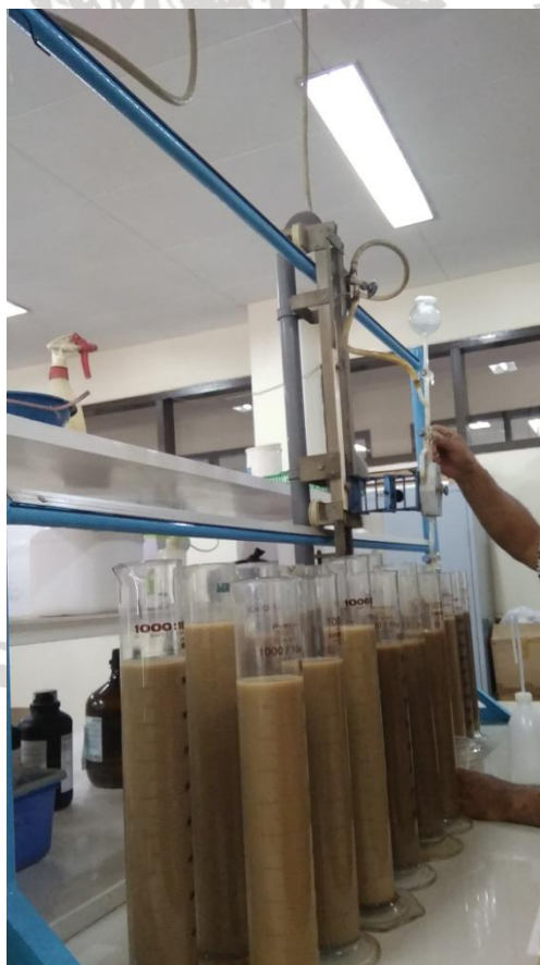
Gambar 19. Kegiatan Pengambilan Cairan dengan Pipet yang Mengandung Fraksi Debu dan Liat pada Sampel Tanah
