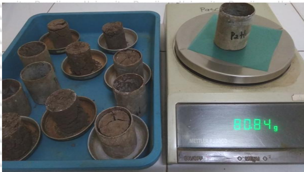
Gambar 20. Penimbangan Massa Sampel Tanah Kering Oven dan Ring untuk Kebutuhan Analisis Berat Isi Tanah
