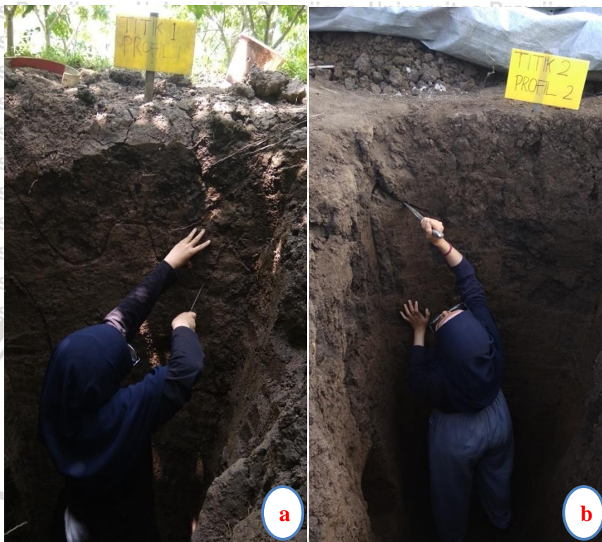
Gambar 12. Penentuan Batas Horizon pada Profil 1 (a) dan Profil 2 (b)
