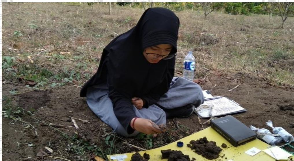
Gambar 13. Penentuan Konsistensi Tanah pada Tanah Sampel Tiap Horizon Profil
