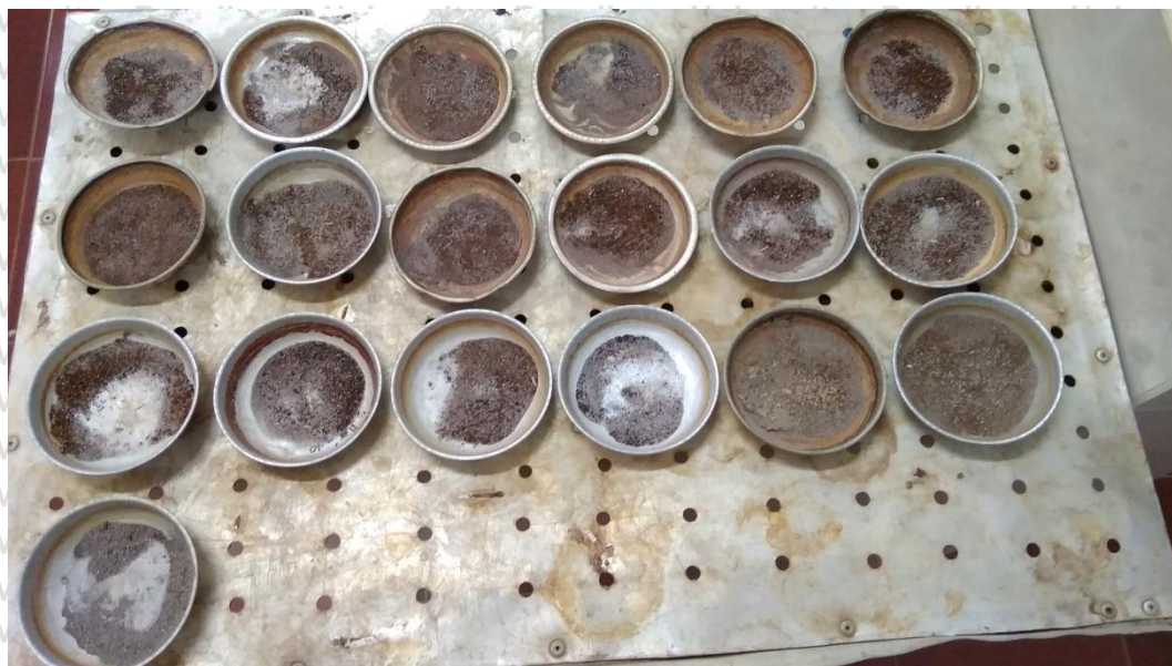
Gambar 24. Hasil Akhir Analisis Tekstur Fraksi Pasir pada Sampel Tanah
