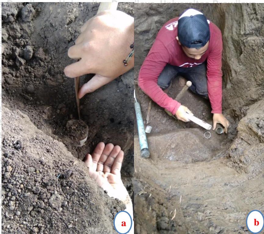
Gambar 14. Pengambilan Ring Sampel Tanah Utuh (a) dan Pelaksanaan Pengambilan Sampel Tanah Utuh pada Tiap Horizon (b)
