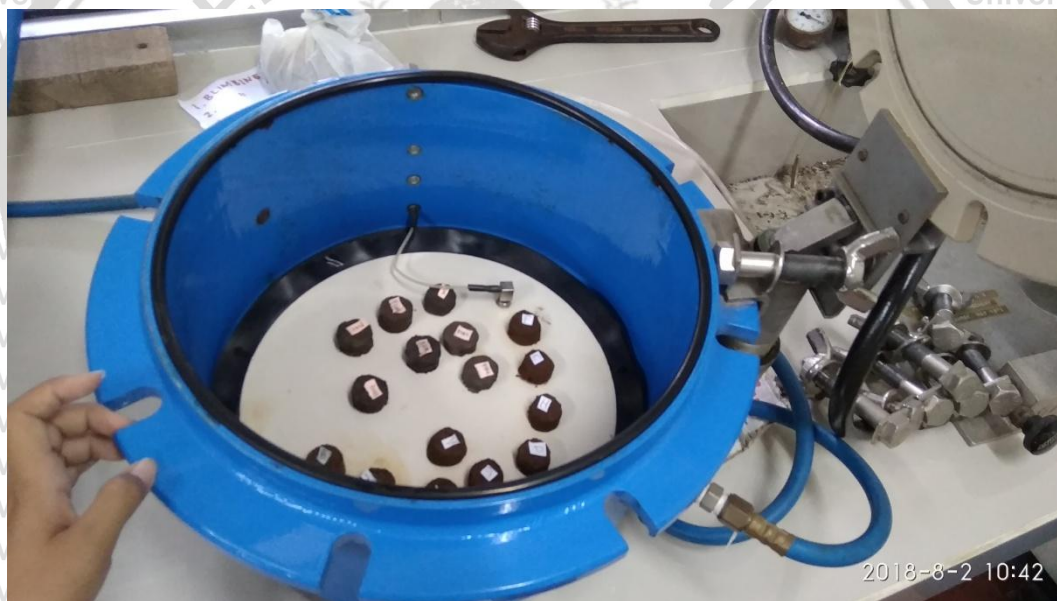
Gambar 21. Persiapan Analisis pF 4,2 Sampel Tanah dengan Pressure Plate Apparatus
