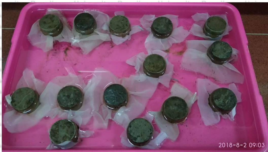
Gambar 22. Penjenuhan Sampel Tanah untuk Kebutuhan Analisis Permeabilitas
