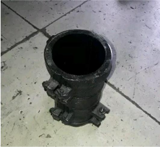
Gambar L 4.13 Cetakan untu benda uji silinder
