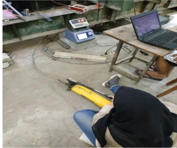
Gambar L 4.22 Hydraulic jack sebagai pemberi beban lateral pada saat pengujian
