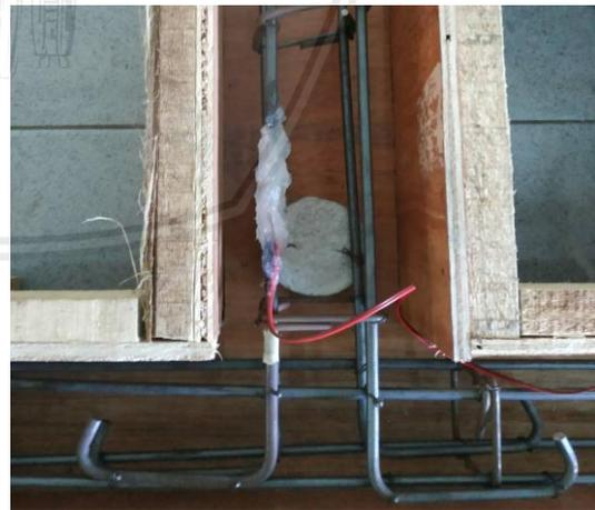
Gambar L 4.6 Hasil akhir pemasangan strain gauge baja
