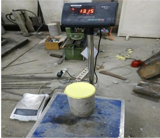
Gambar L 4.19 Pengukuran berat benda uji silinder
