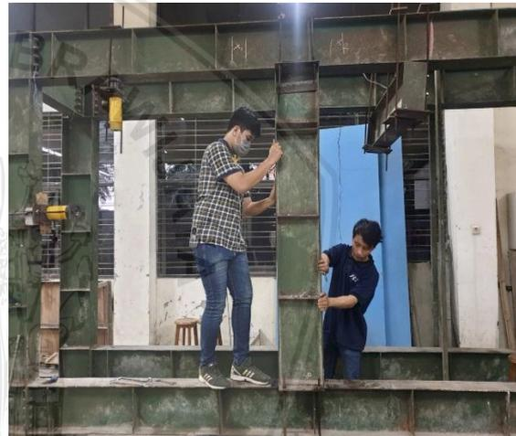
Gambar L 4.17 Setting load frame untuk pengujian benda uji portal
