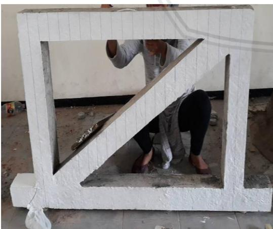
Gambar L 4.15 Proses pengecatan benda uji portal
