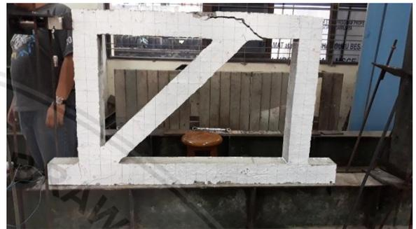
Gambar L 4.28 Benda uji portal E saat terjadi keruntuhan
