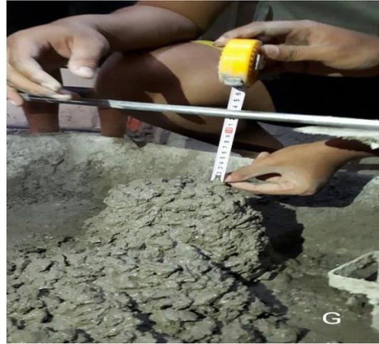
Gambar L 4.10 Pengukuran slump
