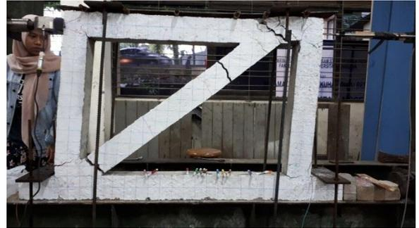
Gambar L 4.28 Benda uji portal D saat terjadi keruntuhan
