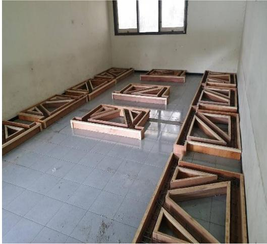
Gambar L 4.7 Bekisting untuk benda uji portal
