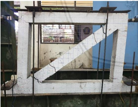
Gambar L 4.27 Benda uji portal A saat terjadi keruntuhan
