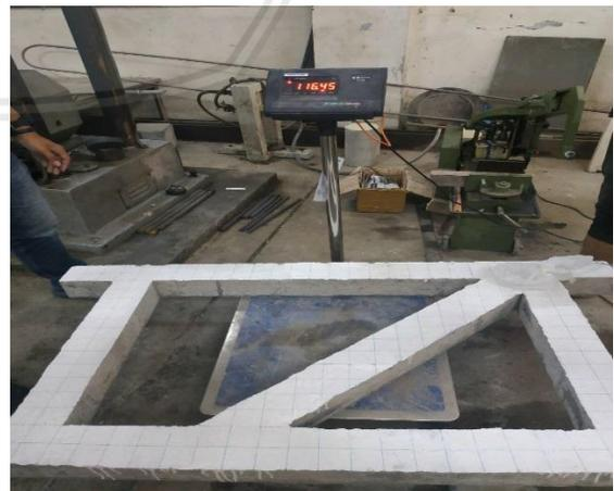
Gambar L 4.18 Pengukuran berat benda uji portal
