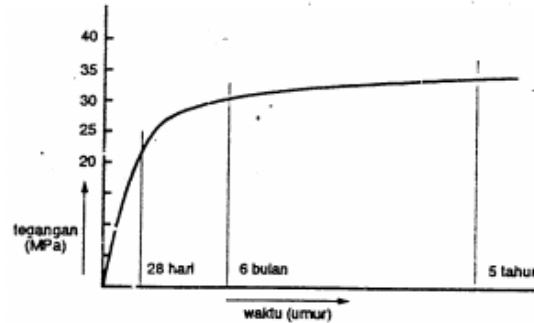
Gambar 2.3 Diagram hubungan kuat beton dengan umur beton
