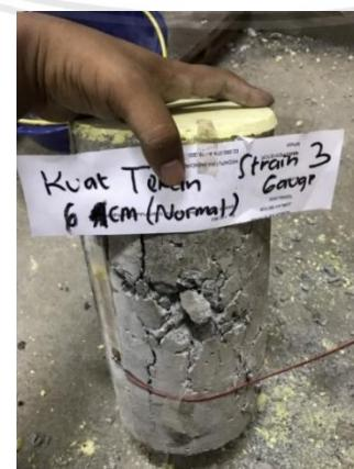
**Gambar 4.5** Hasil Pengujian Kuat Tekan Silinder Beton.
