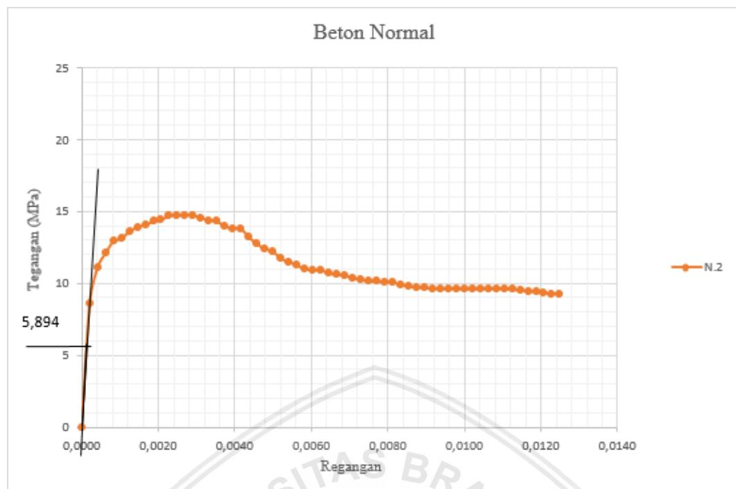
**Gambar 4.14** Grafik Hubungan Tegangan dan Regangan beton normal
