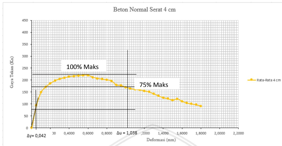
Gambar 4.18 Grafik proses perhitungan daktilitas secan beton normal serat 4cm
