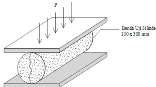
*Gambar 2.4 Uji kuat tarik belah beton silinder*
