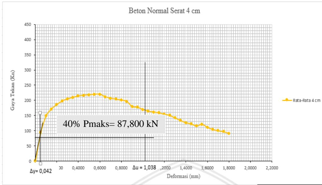
Gambar 4.22 Grafik proses perhitungan kekakuan secan variasi serat 4 cm
