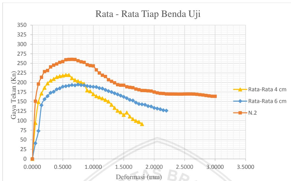
Gambar 4.16 Grafik rata-rata hubungan P beban dan  $\Delta$  tiap benda uji
