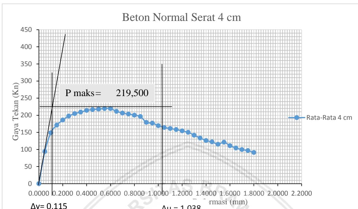
Gambar 4.21 Grafik proses perhitungan kekakuan initial tangan variasi serat 4 cm
