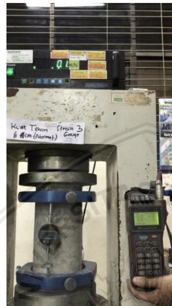
**Gambar 4.4** Proses Pengujian Kuat Tekan Silinder Beton
