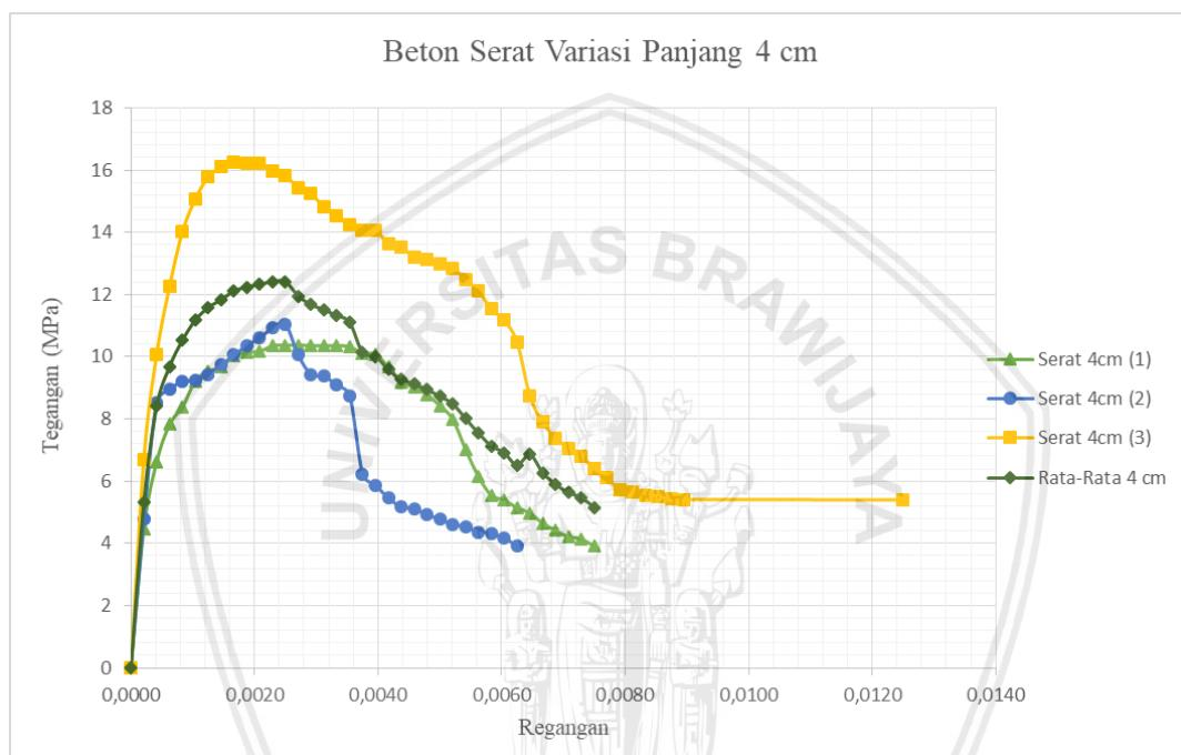
**Gambar 4.11** Grafik Hubungan antara tegangan dan regangan variasi panjang 4 cm
