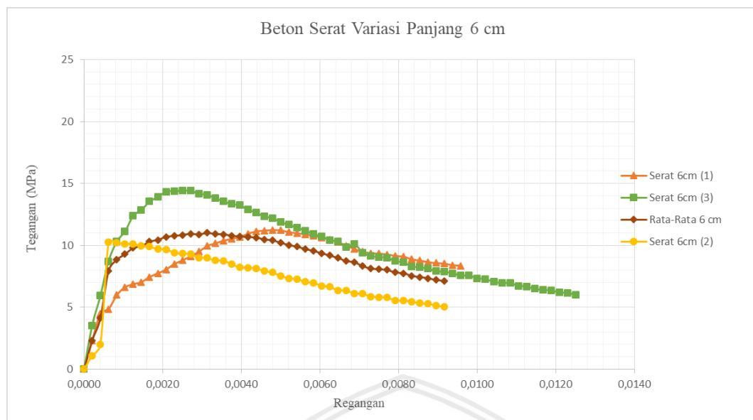
**Gambar 4.12** Grafik Hubungan antara tegangan dan regangan variasi panjang 6 cm
