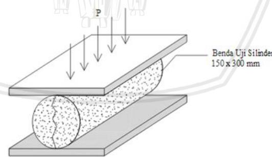
Gambar 3.1 Mekanisme Uji Tarik Belah
