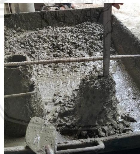
**Gambar 4.1 Proses Uji Slump**
