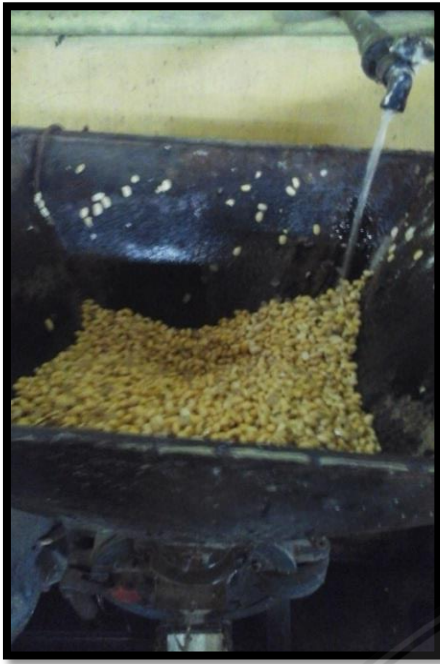
Gambar 2.3 Proses Penggilingan Kedelai
