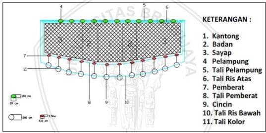
Gambar 1 Konstruksi alat tangkap purse seine
