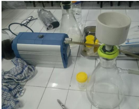
Penyaringan T. chuii menggunakan vacuum pump
