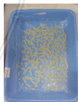
9. Pemindahan mikrokapsul basah ke nampan yang diberi plastik
