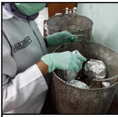
Tabung reaksi yang berisi larutan dimasukkan ke dalam autoclave
