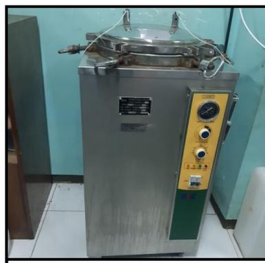
Sterilisasi dilakukan menggunakan autoclave
