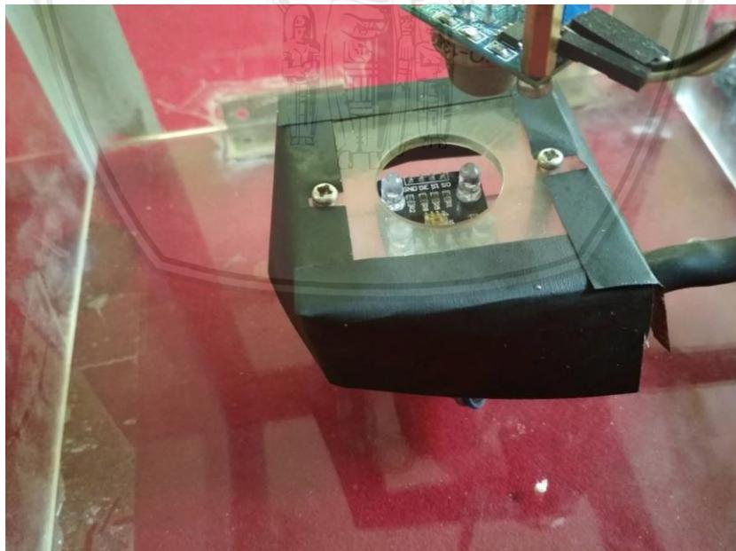
Gambar 5.15 Penempatan Sensor TCS3200
