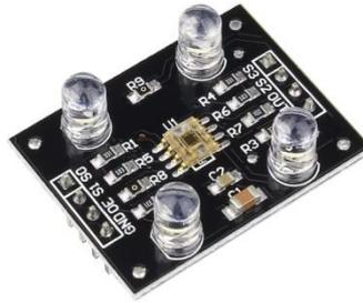
**Gambar 2.4 Sensor Warna TCS3200**
