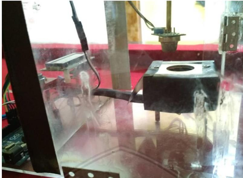
Gambar 5.14 Penempatan Sensor TCS3200
