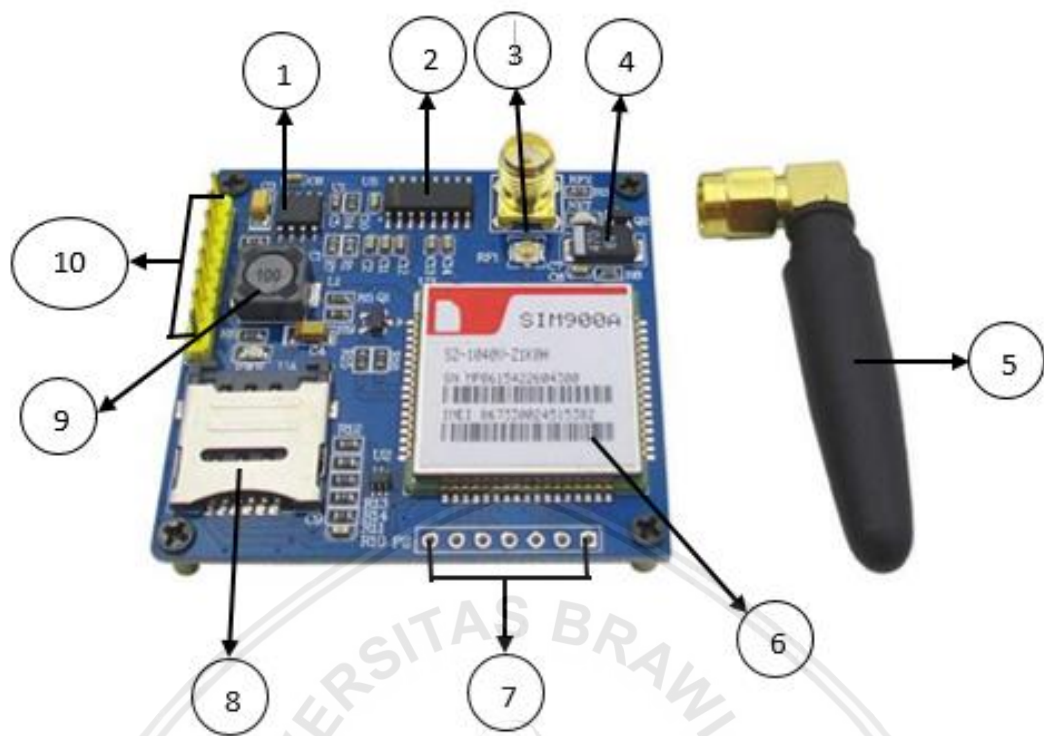
Gambar 2.7 Bentuk fisik modul SIM900A
