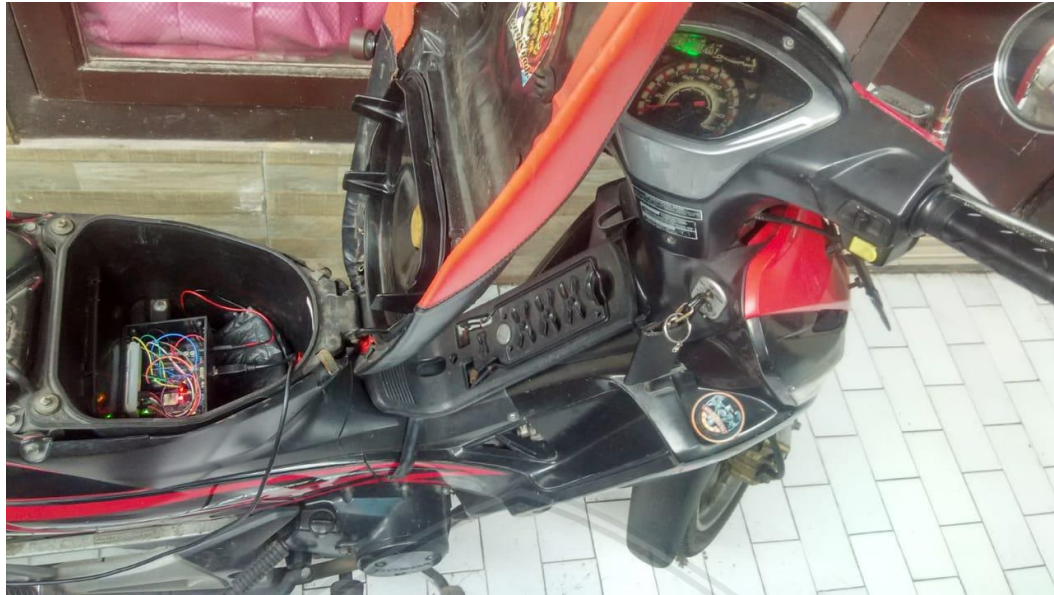
Gambar 6.5 Letak peletakan sensor dan sisem menyala saat stopkontak ON
