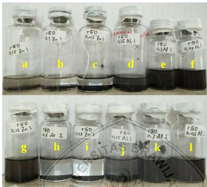
Gambar 4.14: Hasil uji kelarutan grafena hasil reduksi Zn dan Al dalam kloroform.
