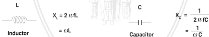
Gambar 2. 3 Reaktansi dalam dua bentuk, Induktansi dan Kapasitansi (Keysight, 2016)
