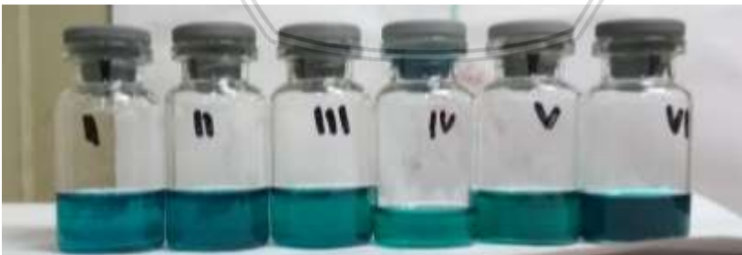
Gambar 4.2: Hasil pelarutan ZnPc dalam campuran benzil klorida-diklorometana menggunakan metode sonikasi.
