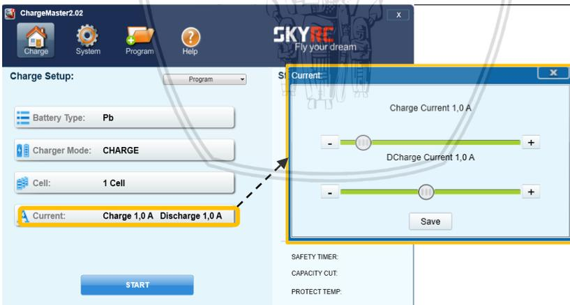
**Gambar 4.7** Tampilan *Charge Setup* (a) serta Pengaturan Nilai Arus Listrik (b) pada *Software ChargeMaster* versi 2.02
