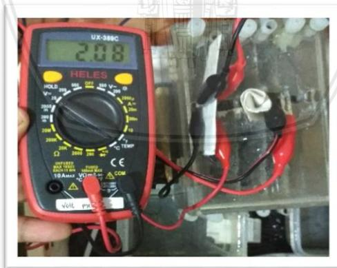
Gambar 4.1 Nilai tegangan *open-circuit* baterai dinamis asam timbal pada keadaan awal.
