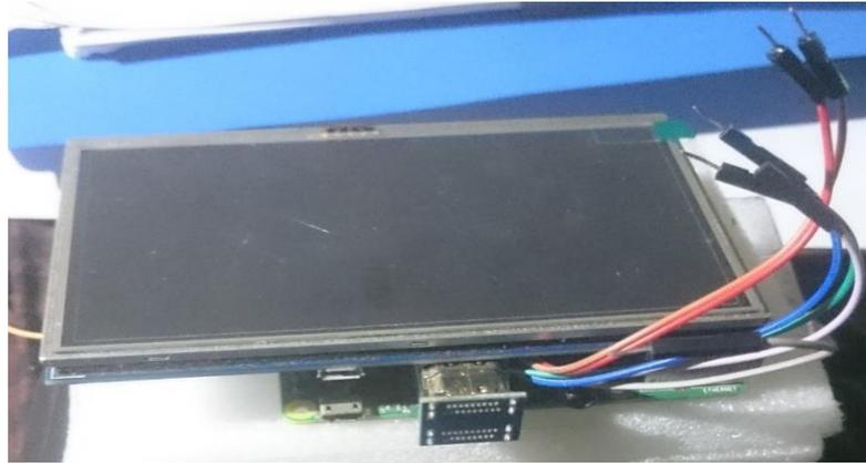
**Gambar 5.13 Implementasi Rangkaian Display LCD 800 x 480**
