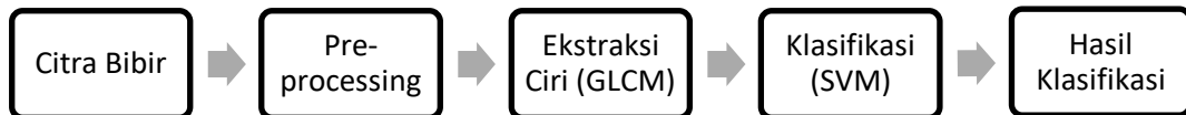
Gambar 3.4 Tahapan-tahapan dari sistem klasifikasi pola sidik bibir untuk menentukan jenis kelamin manusia
