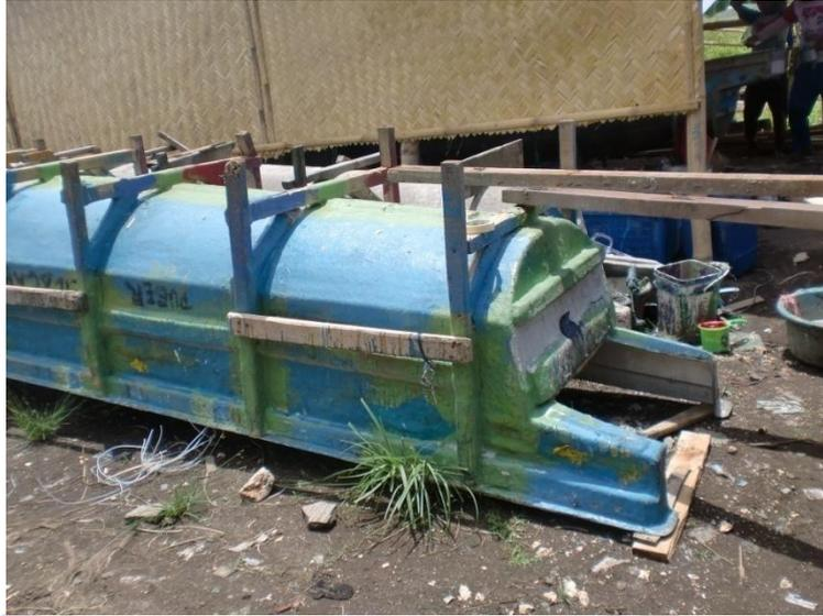
**Gambar 5.** Gambar cetakan Jukung *Fiberglass* bagian belakang yang ada di Galangan Tradisional di Puger. (Sumber : data lapang)
