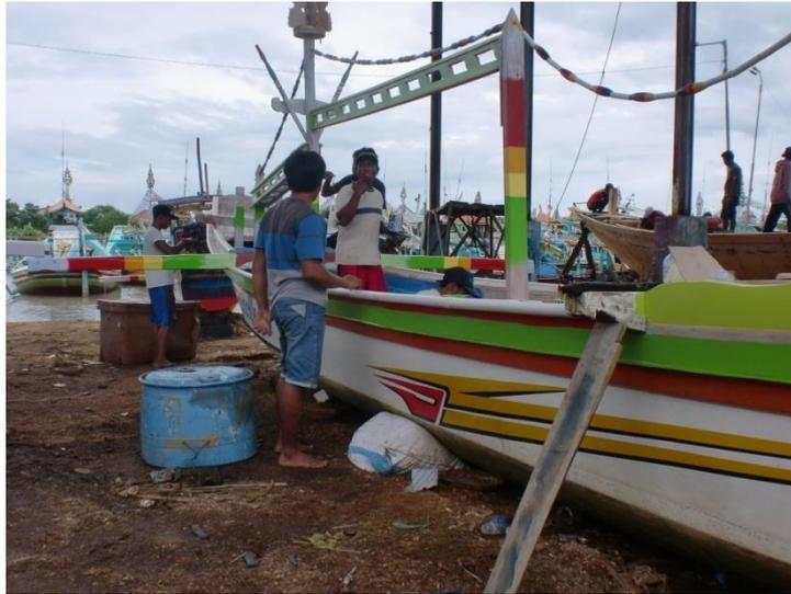
**Gambar 4.** Proses Pengecatan Jukung Kayu yang ada di Galangan Kapal Tradisional di Puger (*Sumber: data lapang*)
