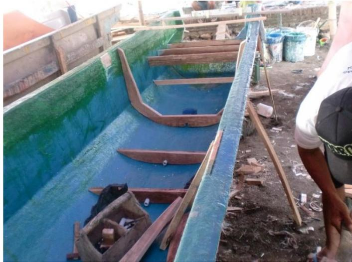
**Gambar 8.** Pemasangan Gading pada Jukung *Fiberglass* (Sumber; Data lapang)
