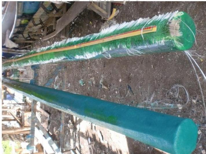
**Gambar 9.** Pembuatan katir yang dilapisi dengan bandeller dan matt.
