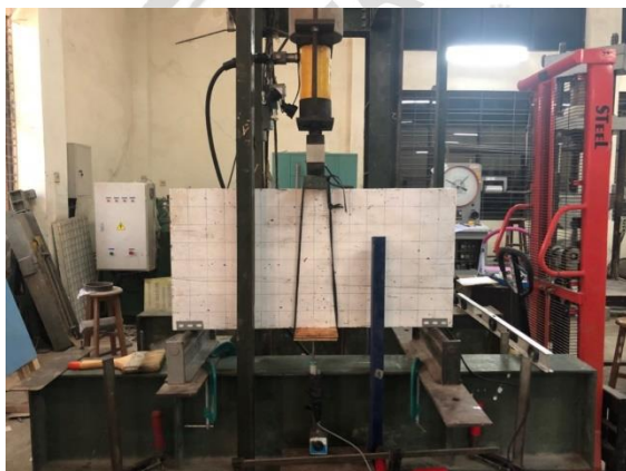
Gambar L 4.20 Pembebanan pada panel
