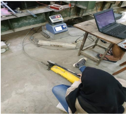
Gambar L 4.24 Pemberian beban dengan menggunakan hydraulic jack
