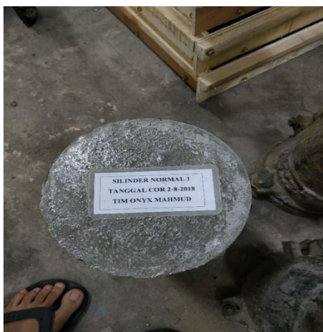
Gambar L 4.15 Benda uji silimnder
