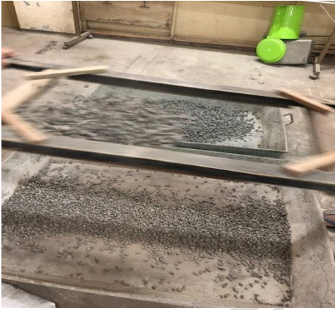
Gambar L 4.8 Pengayakan agregat kerikil
