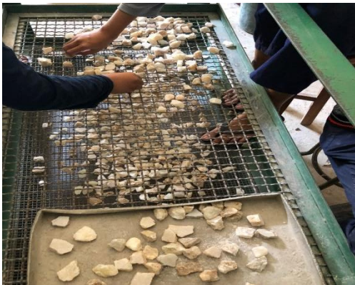
Gambar L 4.3 Pengayakan agregat onyx
