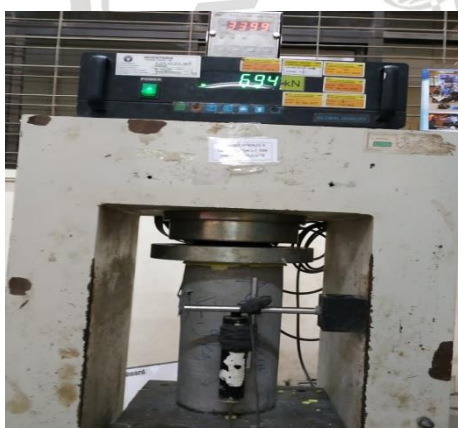
Gambar L 6.16 Uji kuat tekan silinder
