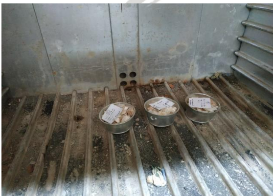
Gambar L 4.4 mengoven agregat onyx untuk memeriksa kadar air
