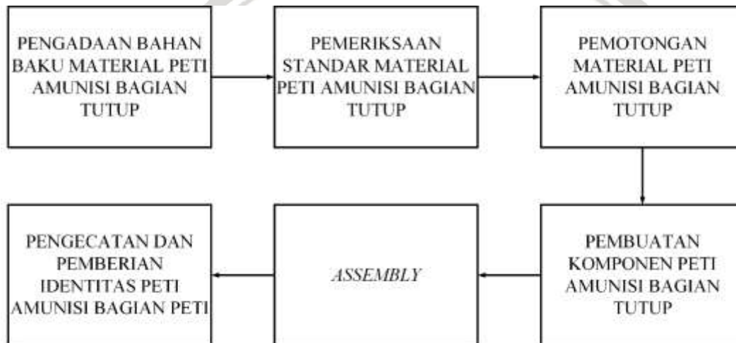
Gambar 4.2 Proses Pembuatan Bagian Tutup Peti Amunisi
